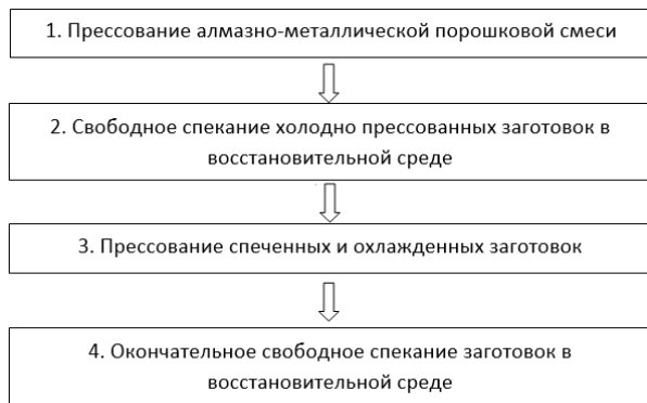
Рисунок 1 – Технологическая схема изготовления алмазно-металлических композитов
