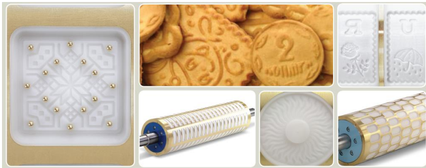
Рисунок 5 – Формующая оснастка для производства сахарного печенья
