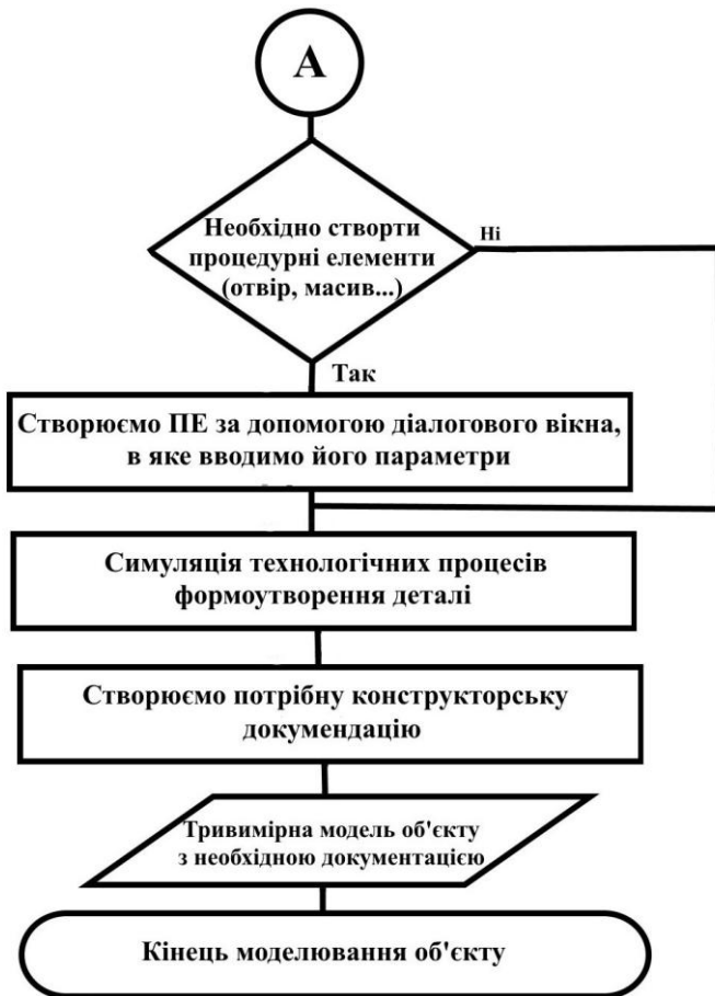
Рисунок 1 – Алгоритм створення тривимірної моделі деталі у синхронному середовищі САПР Solid Edge
