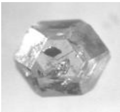
Рисунок 1 – Снимок монокристалла алмаза с локальным включением металла-катализатора
