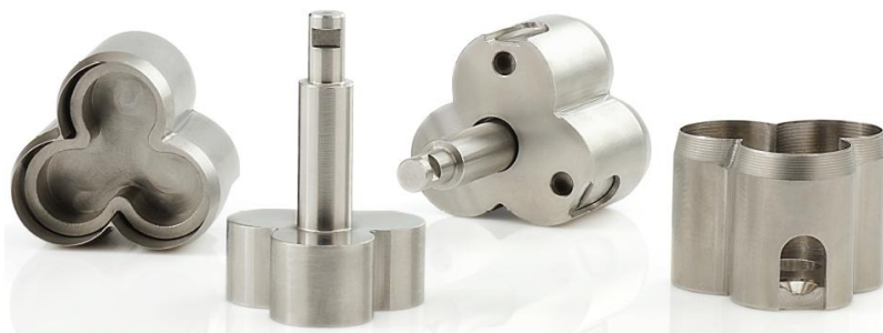
Рисунок 4 – Оснастка для производства пряников
